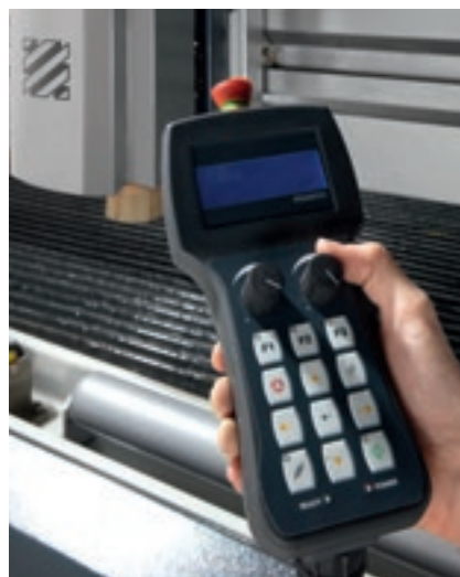
Mobile Konsole mit Touch-Bildschirm. Eine moderne und intuitive Oberfläche für eine einfache Maschinenverwaltung.
